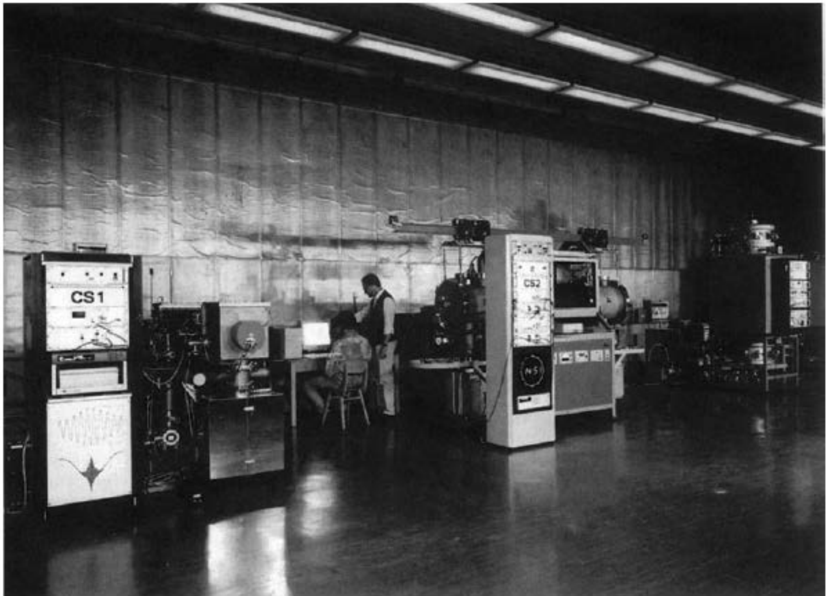
Abb. 1.4 Die Cäsium-Atomuhren CS1, CS2 und CS3 der PTB Braunschweig, aufgestellt in der abgeschirmten und klimatisierten Atomuhrenhalle
