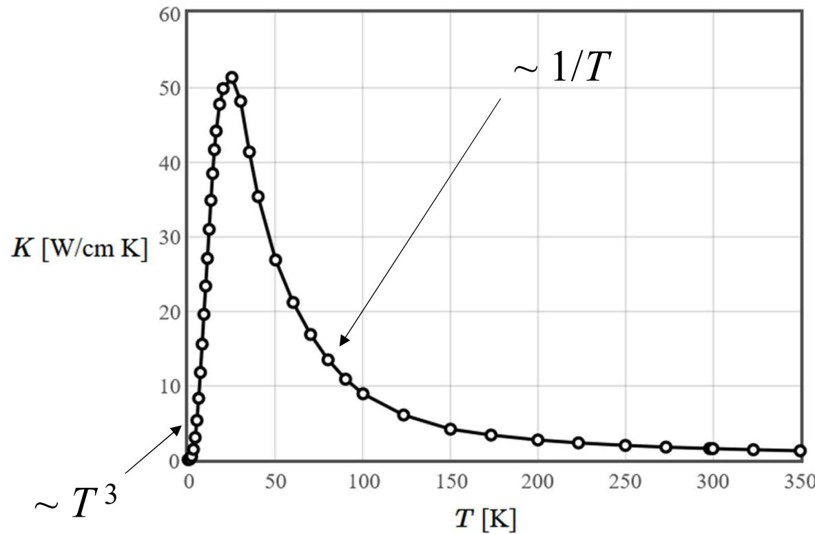
The thermal conductivity of silicon.[\[1\]](#)
