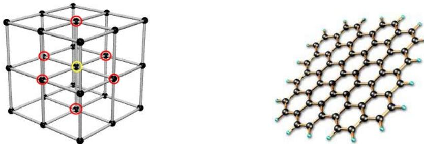
Abbildung 2.11: Im linken Bild sind 8 (sc)-Elementarzellen abgebildet. Die nächsten Nachbarn des gelb eingerahmten Atoms sind die rot eingerahmten Atome, die alle gleich weit vom roten Atom entfernt sind. Es ergibt sich also eine Koordinationszahl von 6 (Quelle: [www.4dsolutions.net](http://www.4dsolutions.net)).
